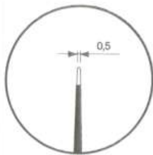
017 653 gerade, stumpf straight, blunt tips
