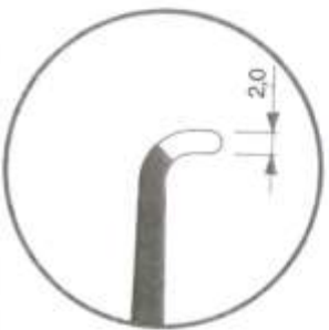
017 696 bayonettförmig, gebogen, stumpf bayonet, curved blunt tips
