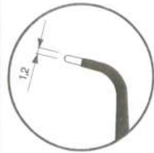
017 632 bayonettförmig, nach unten gebogen bayonet, curved downwards blunt tips
