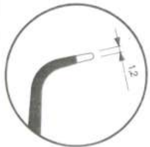
017 633 bayonettförmig, nach oben gebogen, stumpf bayonet, curved upwards blunt tips
