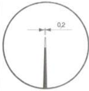
017 622 bayonettförmig, spitz bayonet, sharp tips
